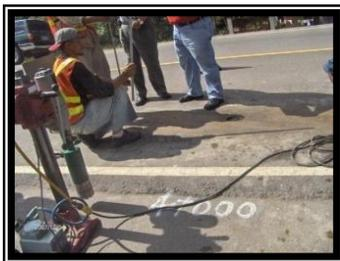
Aproximadamente en la semana del 17- 21 de septiembre de 2007 se realizaron pruebas a una distancia de 500 metros entre ellas, en Zig Zag o sea una en carril derecho y otra en carril izquierdo, se comenzó en el kilómetro 17 hacia el inicio del proyecto En la fotografía se aprecia la prueba realizada en la estación 4+000 a una profundidad de 80cm con un DSP (Cono Dinámico de Penetración).
